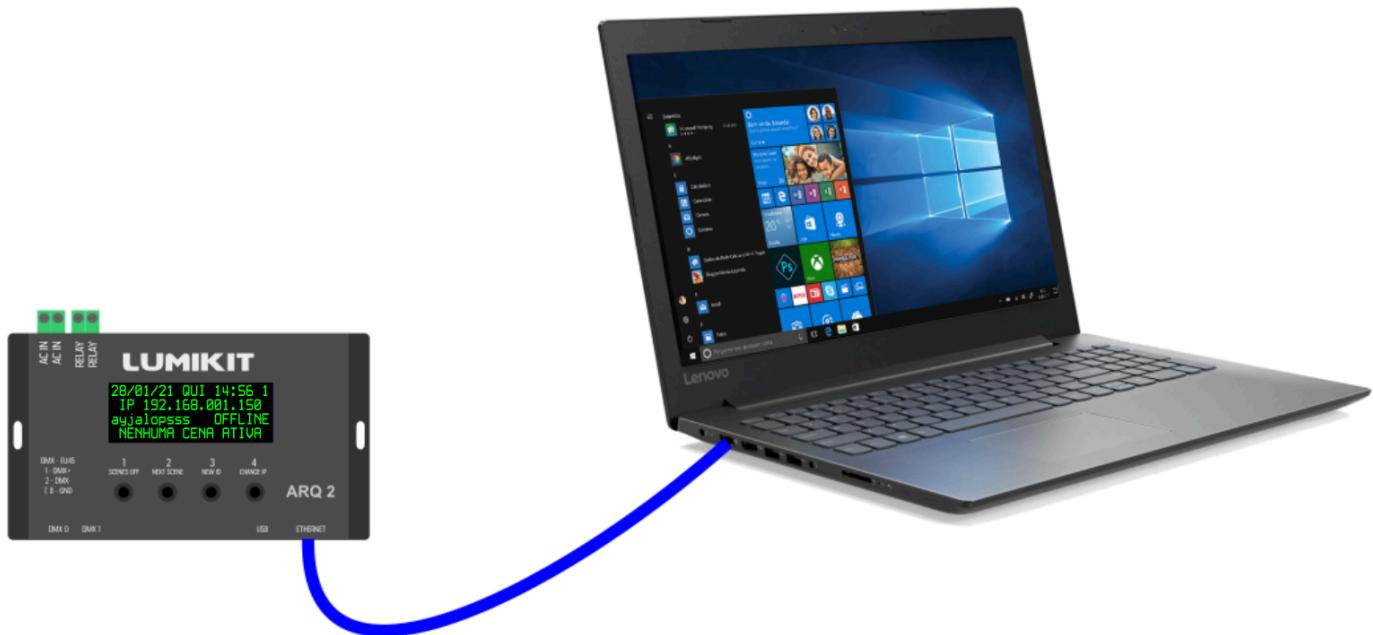
No computador pelo Painel de controle, configure um IP fixo, por exemplo 192.168.0.10 no adaptador de rede ETHERNET.
