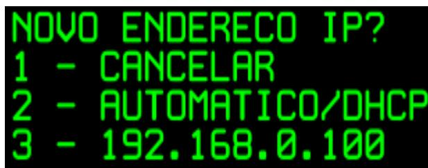
Pressione o botão “2” para usar um IP automático, o display mostrará o IP 000.000.000.000 até conseguir um IP com o servidor DHCP na rede local, indicado para casos onde não se usem as saídas Art-Net;
